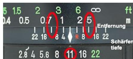
Abbildung 1.34: Einstellungen bei einem Fotoapparat: Entfernung ca. 1.2 m, Blende 11, Schärfentiefe von ca. 0.8 m bis 5 m.
